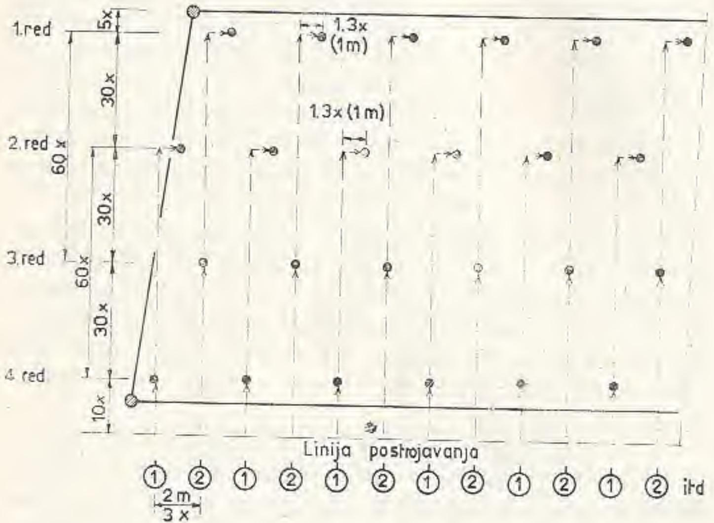
Sl. 16 — Način raspoređivanja protivtenkovskih mina strojnim rasporedom — drugi način
